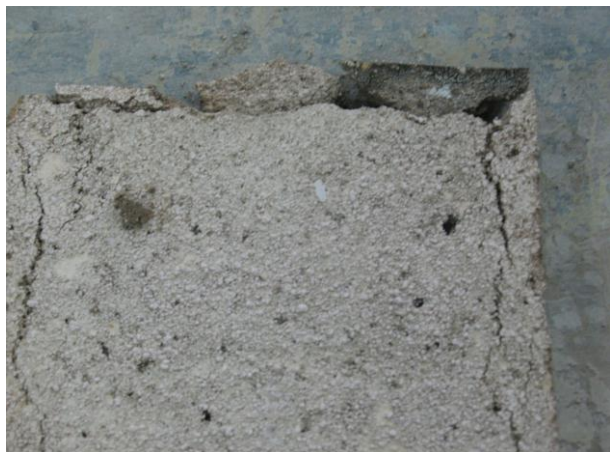
Рис. 1. Образец эталонного бетона без добавки шунгита при температуре испытания 1100^\circ\text{C}
