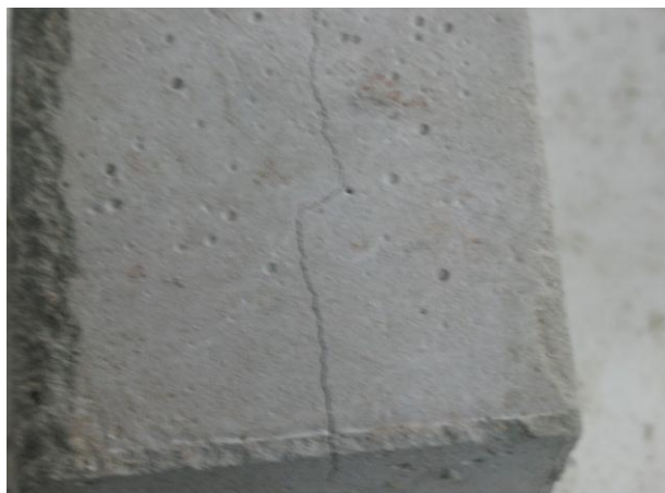
Рис. 2. Образец термостойкого бетона с добавкой шунгита при температуре испытания 1100^\circ\text{C}
