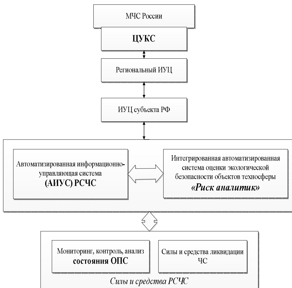
Рис. 2. Схема внедрения «Риск-аналитик» в систему АИУС РСЧС для обеспечения экологической безопасности
