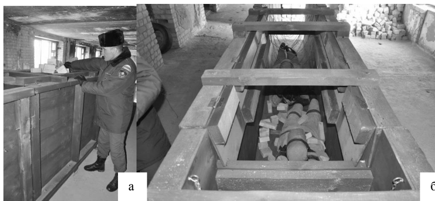
Рис. 3. Блок с тренировочными элементами обрушения потолка: тренажер перед обрушением (а), обрушение потолка (б)
