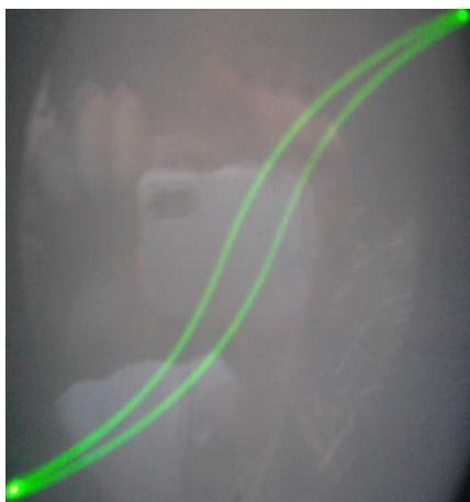
Рис.4. Петля гистерезиса композита поливиниловый спирт- \text{NaNO}_2
