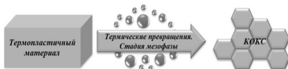
Рис. 1. Условная схема термической деструкции термопластичных материалов
