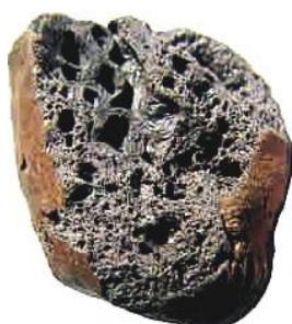
Рис. 3. Гранула керамзитового гравия в разрезе
