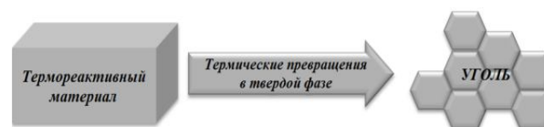
Рис. 2. Условная схема термической деструкции термореактивных материалов
