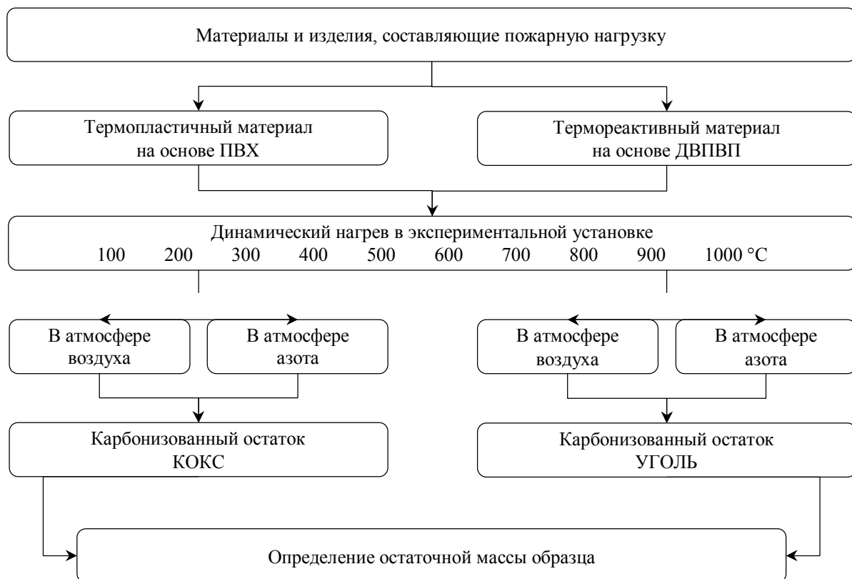
Рис. 3. Схема проведения экспериментальных исследований
