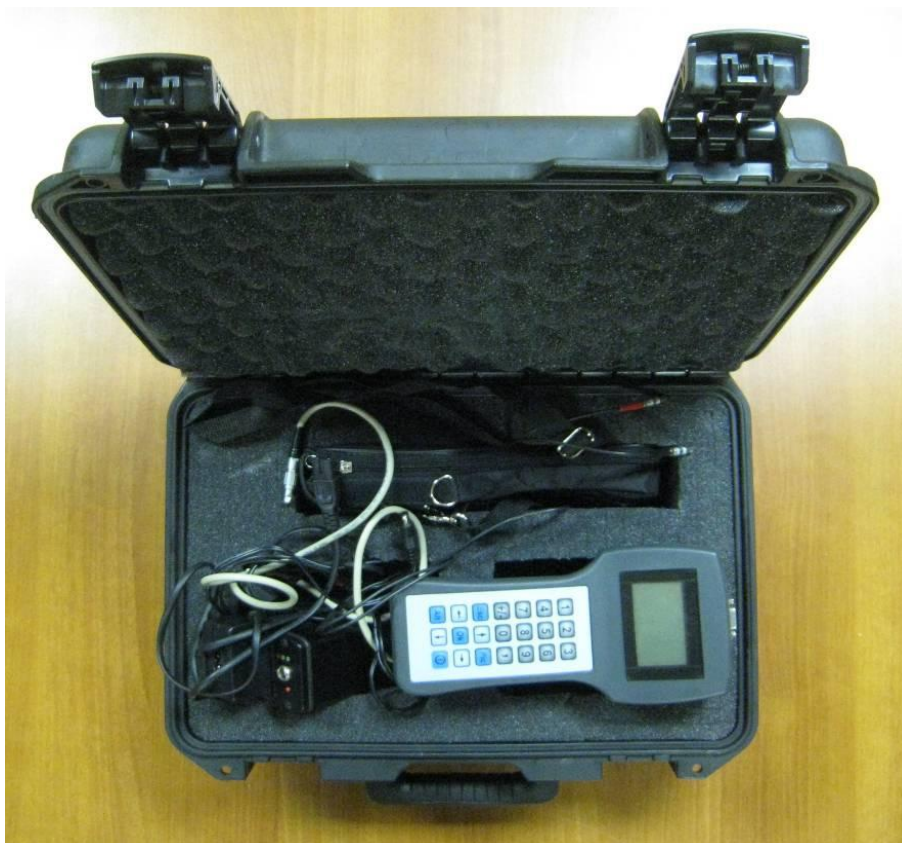
Рис. 5. Модифицированный вариант комплекса УРСДУП – УДКС-01 (Устройство динамического контроля струнное).
