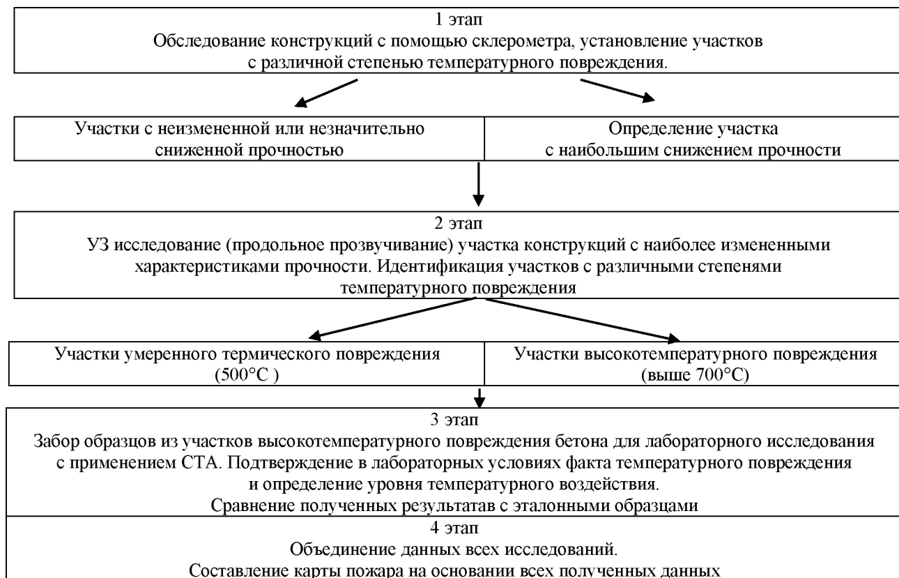
Рис. 1. Алгоритм применения отдельных методов исследования прочности бетонных композитов для определения зон термического повреждения при установлении скрытого очага пожара
