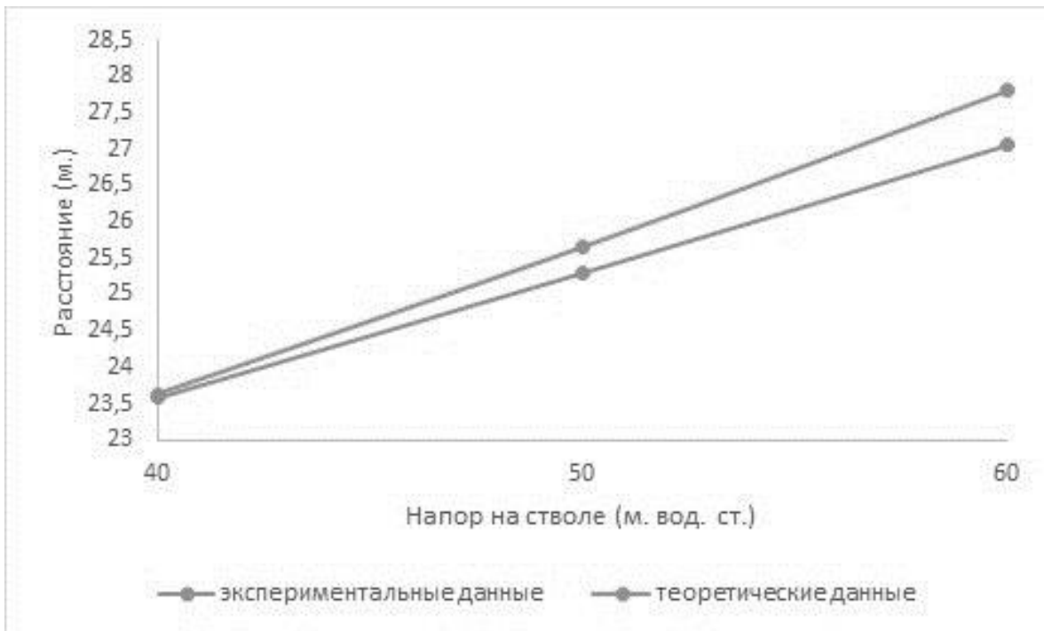
Рис. 3. Дальность струи при угле наклона ствола 60 градусов к горизонту
