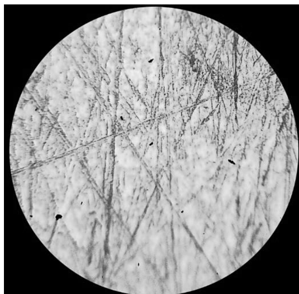
Рис. 4. Микрофотография исходной поверхности образца трения из стали 45 (увеличение в x400).
