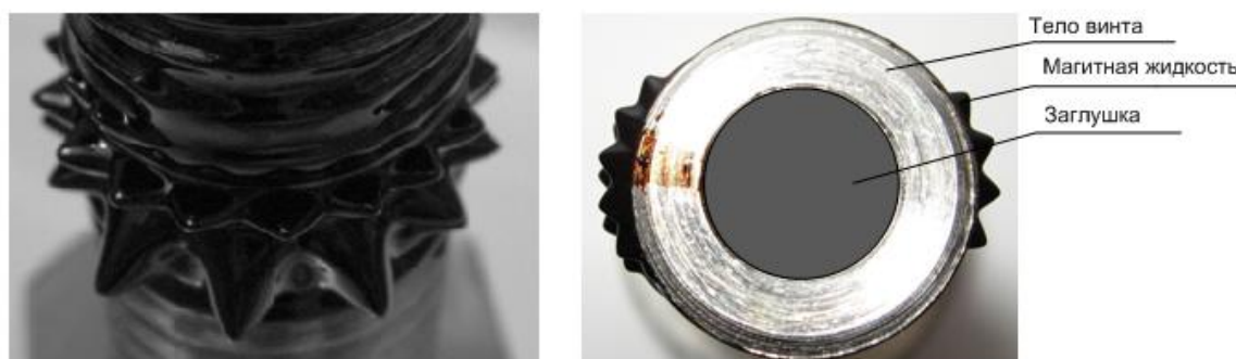
Рис. 1. Резьбовая поверхность винта с нанесенной на неё магнитной смазочной жидкостью: а – рабочая поверхность; б – торцевая поверхность.
