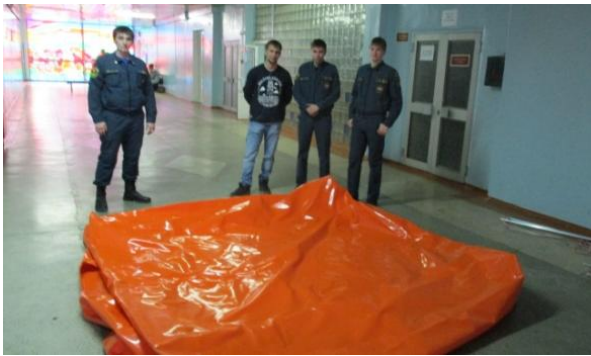
Рис. 4. Подготовка макета спасательного средства к установке. Геометрические характеристики макета: A=2,5 ; B=2,5 ; H=1,5 ; d=0,5
