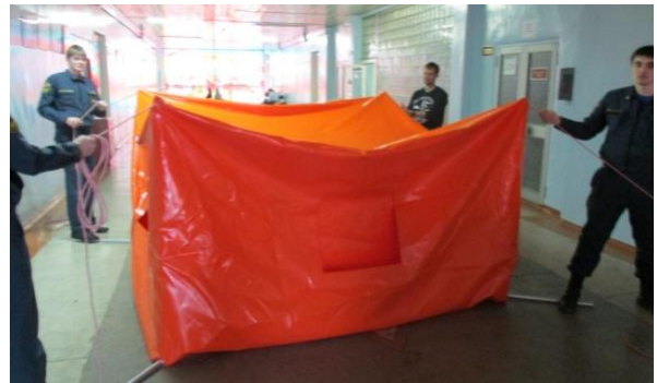
Рис. 4. Подготовка макета спасательного средства к установке. Геометрические характеристики макета: A=2,5 ; B=2,5 ; H=1,5 ; d=0,5
