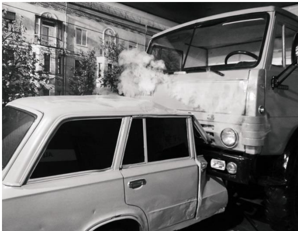
Рис. 1. Изображение модуля 1, имитирующего лобовое столкновение и наезд КАМАЗа на переднюю часть автотранспортного средства ВАЗ - 2102 с имитацией возгорания при помощи дымогенератора и модуля 4, имитирующего опрокидывание автотранспортного средства ЗАЗ
