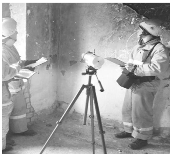
Рис. 5. Пример отработки обучающимися практических навыков: фиксация тепловых зон в очаге пожара
