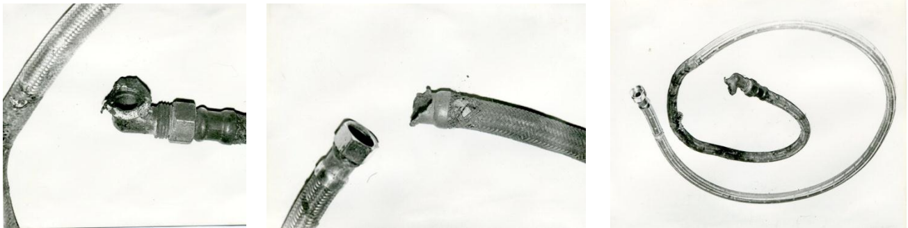
Рис. 3. Термические поражения гибких шлангов (подводок) к электрогазовым плитам (выделены пунктиром) [3].
