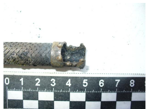
Рис. 4. Локальные термические поражения гибкого газового шланга [4]
