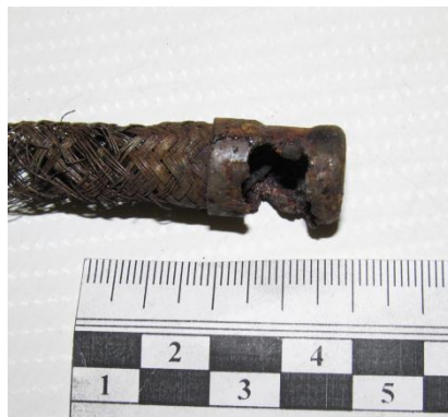
Рис. 7. Муфта крепления гибкого шланга в двух проекциях (а, б, в), сохранившаяся муфта гибкой подводки. (стрелкой показаны сохранившиеся обугленные нити льняного волокна)
