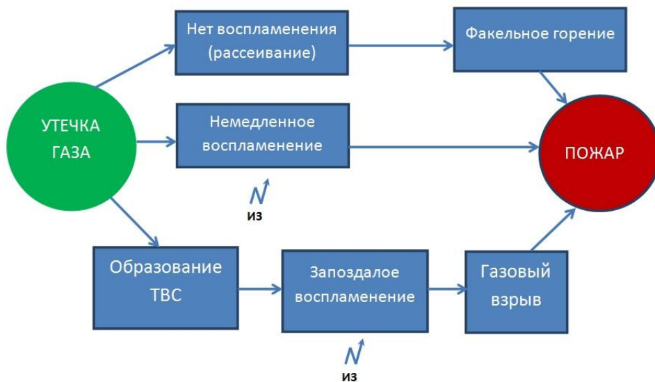
Рис. 1. Древо событий при утечке горючего газа в помещение (ИЗ – источник зажигания)
