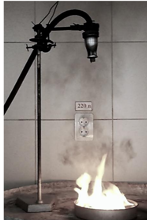
Рис. 3. Общий вид проведения испытания на огнетушащую эффективность
