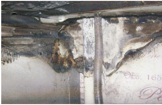
Рис 10. Взаимное расположение гофрошланга (гибкой газовой подводки) и газовой трубы (стояка) а) прохождение газовой трубы и сильфонного шланга через отверстие в столешнице кухонного стола. б) место соприкосновения (контакта) сильфонного шланга и газовой трубы под столешницей
