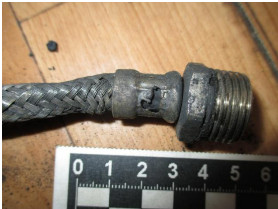
Рис. 5. Проплавление втулки газового шланга
