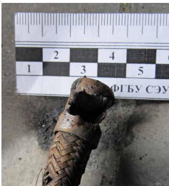
Рис. 7. Муфта крепления гибкого шланга в двух проекциях (а, б, в), сохранившаяся муфта гибкой подводки. (стрелкой показаны сохранившиеся обугленные нити льняного волокна)
