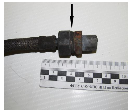
Рис. 7. Муфта крепления гибкого шланга в двух проекциях (а, б, в), сохранившаяся муфта гибкой подводки. (стрелкой показаны сохранившиеся обугленные нити льняного волокна)
