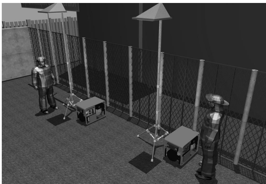
Рис. 5. Место установки оборудования для организации освещения участка проведения аварийно-спасательных работ
