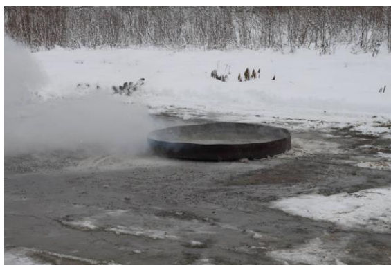
Рис. 6. Ликвидированный модельный очаг пожара (Класс 55В) в результате воздействия огнетушащего порошкового состава на основе «Волгалит-АВС» с применением ГМД в концентрации 1,5% (по массе)
