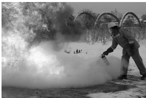
Рис. 5. Тушение модельного очага пожара (Класс 55В) огнетушащим порошковым составом на основе «Волгалит-АВС» с применением ГМД в концентрации 1,5 % (по массе)
