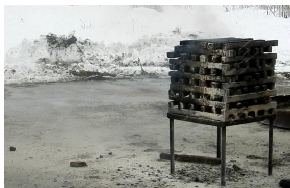
Рис. 3. Ликвидированный модельный очаг пожара (Класс 1А) в результате воздействия огнетушащего порошкового состава на основе «Волгалит–АВС» с применением ГМД в концентрации 1,5 % (по массе)
