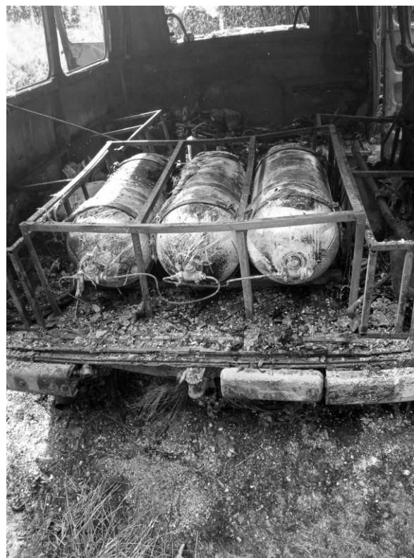
Рис. 3. Фото ГБО в салоне сгоревшего автомобиля
