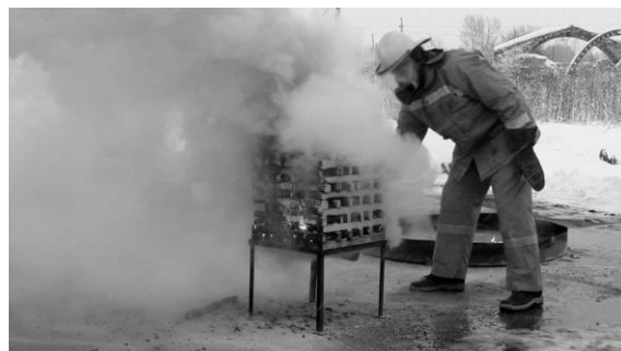
Рис. 2. Тушение модельного очага пожара (Класс 1А) огнетушащим порошковым составом на основе «Волгалит–АВС» с применением ГМД в концентрации 1,5% (по массе)
