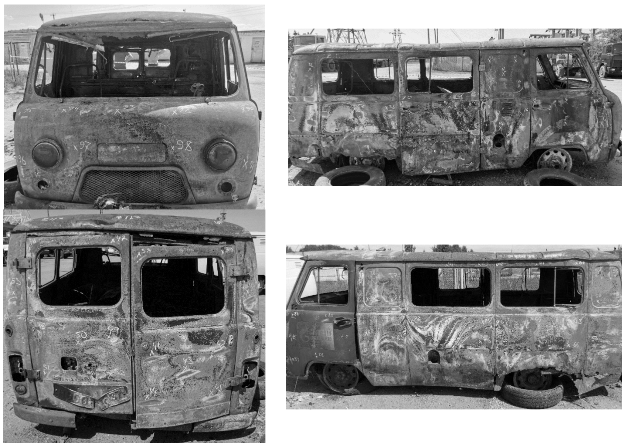
Рис. 5. Фото сгоревшего автомобиля УАЗ 396255 подготовленного к проведению исследований методами вихретокового и магнитного зондирования
