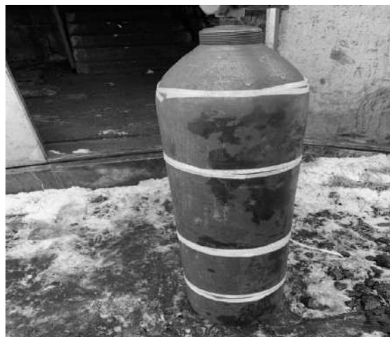
Рис. 1. Макет газового баллона с визуальным идентификатором (светоотражающая лента)
