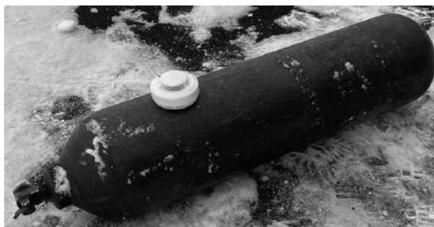
Рис. 2. Макет газового баллона со звуковым идентификатором (ДИП)
