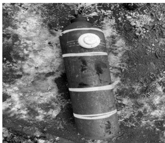
Рис. 3. Макет газового баллона с комбинированным способом использования идентификаторов (ДИП и светоотражающая лента)
