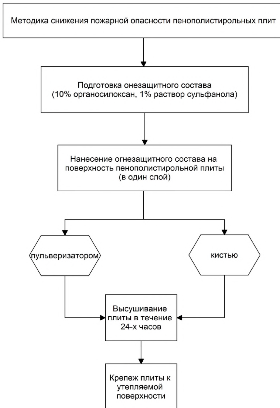
Рис. 2. Методика снижения пожарной опасности пенополистирольных плит
