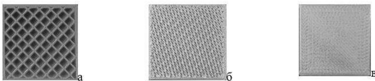
Рис. 4 Фотографии внутренней структуры образцов с различной плотностью заполнения: а – 20 % заполнение, б – 80 % заполнение, в – 100 % заполнение
