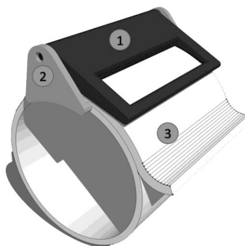
Рис. 4. Ленточный зажим: 1 – рукоятка, 2 – корпус, 3 – текстильный материал
