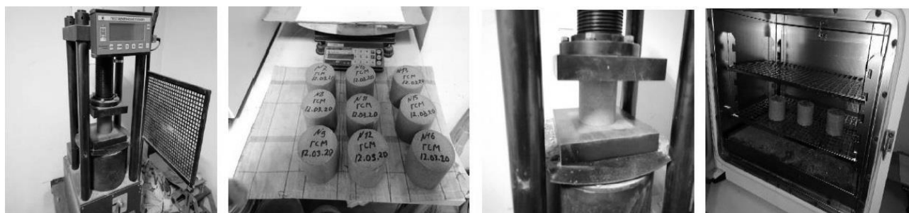
Рис. 6. Испытания для определения прочности материалов при сжатии и водопоглощения образцов
