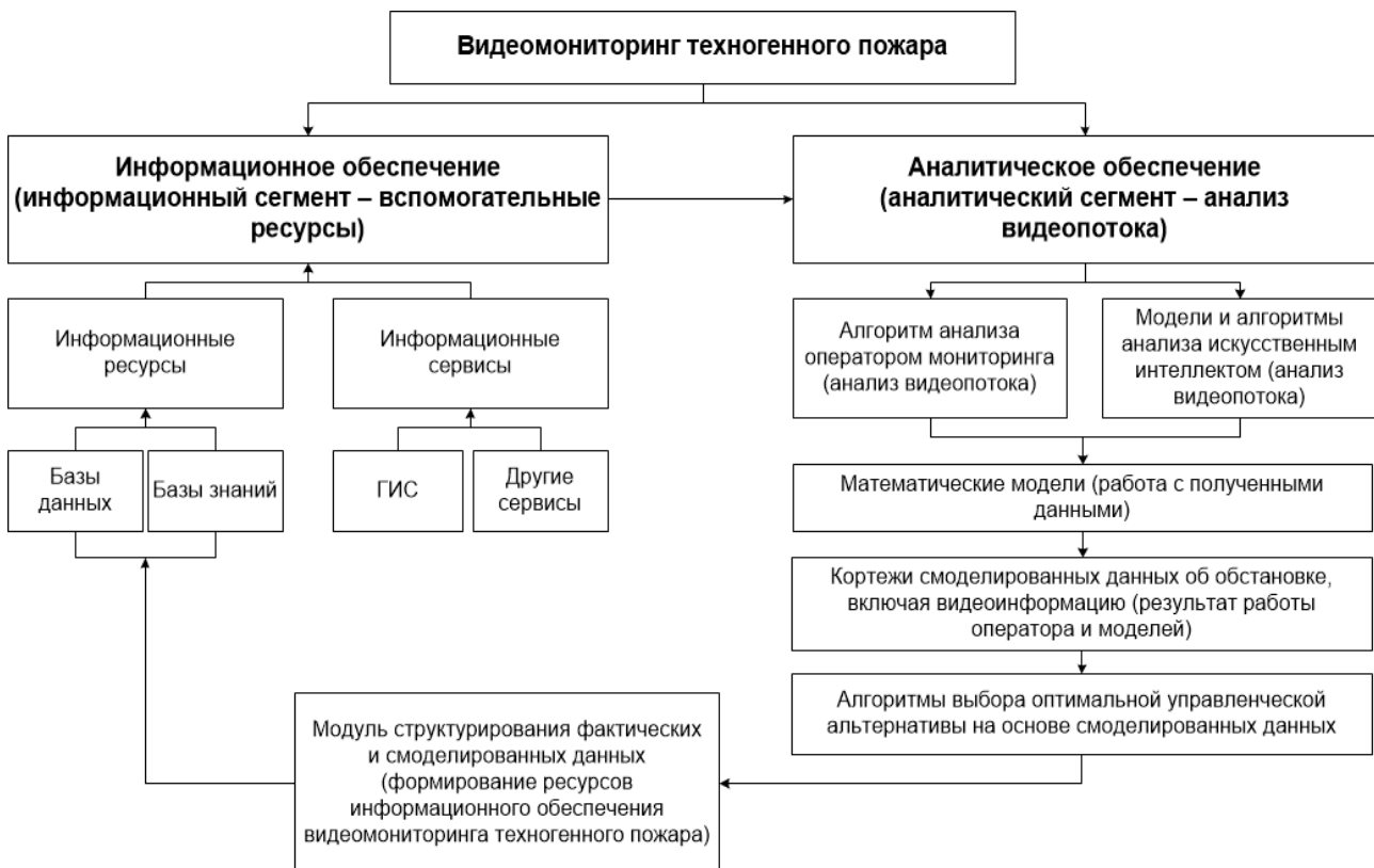
Рис. 1. Концептуальная схема информационно-аналитического сопровождения (ИАСВ) видеомониторинга техногенного пожара
