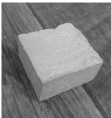
Рис. 1. Образцы штукатурных растворов для исследования грибостойкости
