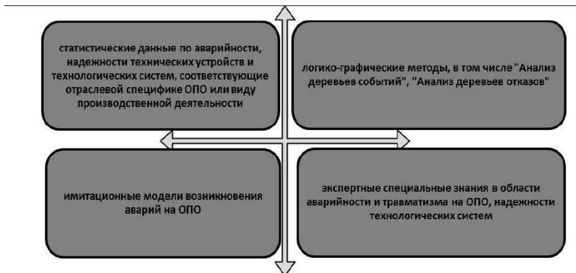
Рис. 4. Виды информации для оценки частоты инициирующих и последующих событий в сценариях аварий на ОПО 5
