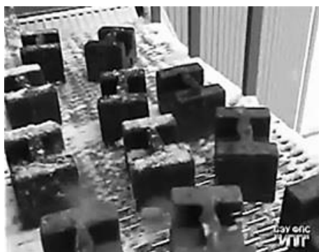
Рис. 2. Испытание площадки наружной пожарной стационарной лестницы распределённой нагрузкой
