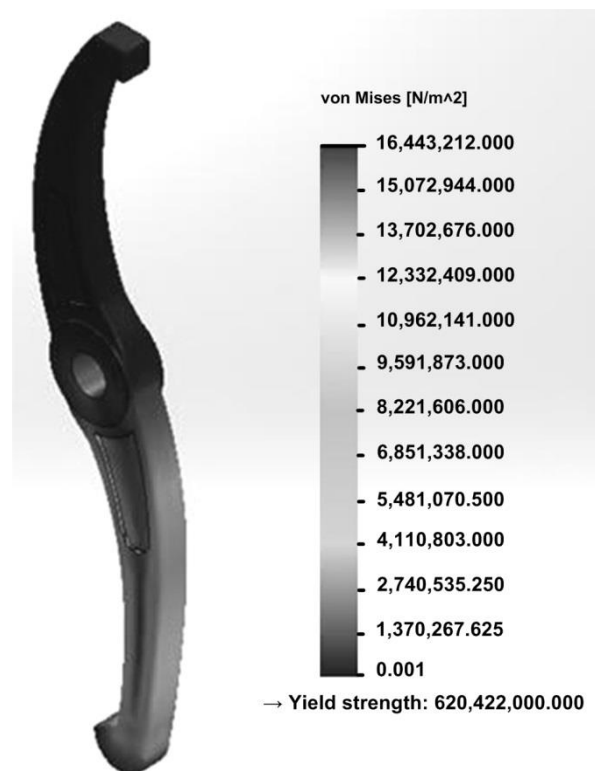
Рис. 5. Распределение напряжений по сечению захвата
