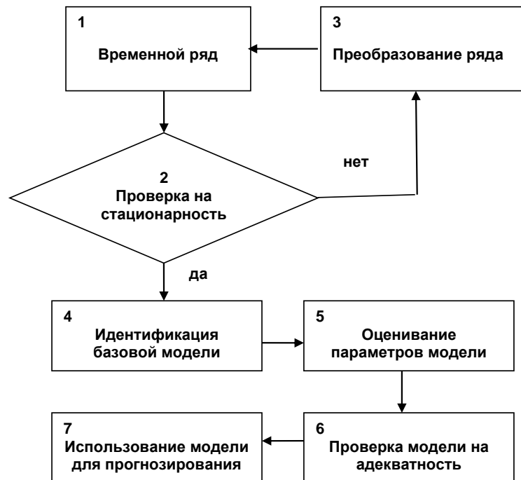
Рис. 2. Укрупненная структурная схема алгоритма построения модели ARIMA
