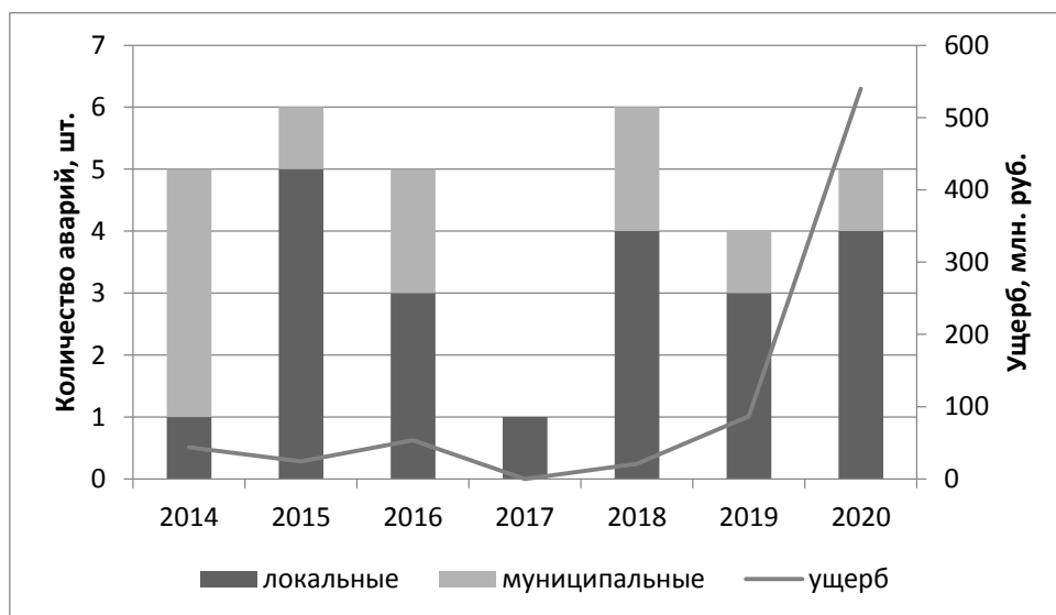
Рис. 1. Количество аварий и нанесенного ущерба на магистральных и внутрипромысловых нефтепроводах на территории России
