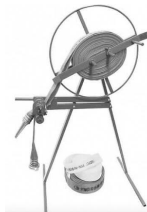
Рис. 1. Станок для намотки рукавов в скатку и перемотки на новое ребро «Балтика-01 П»
