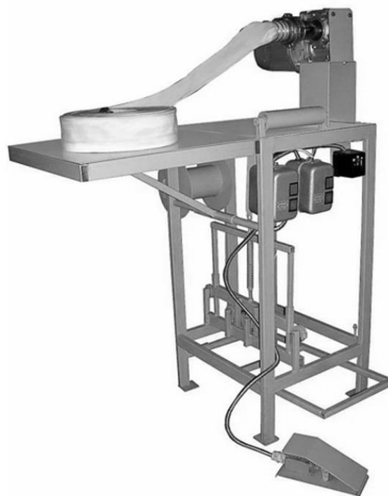
Рис. 2. Станок для навивки пожарных рукавов на соединительные головки «ТЦ-15»
