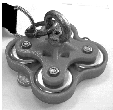
Рис. 4. Экспериментальный образец СМП-120 для открывания и закрывания крышки люка водопроводного колодца
