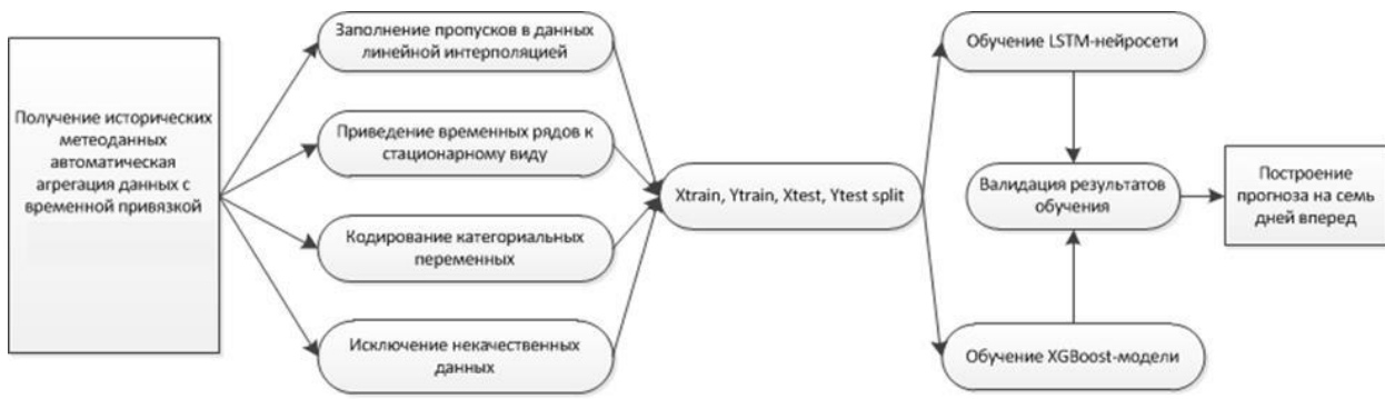
Рис. 1. Общая структура этапов построения модели прогноза подъема уровня паводковых вод, вызванных весенним половодьем
