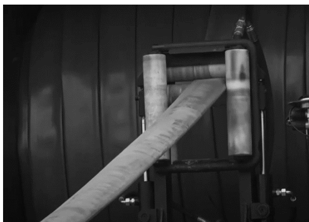
Рис. 2. Общий вид устройства по автоматическому сбору рукавной линии
