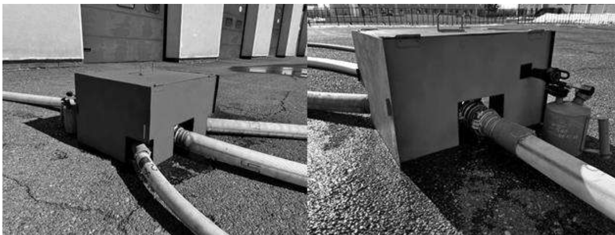
Рис. 2. Вид разработанного авторами компактного раскладного устройства, позволяющего повысить эффективность работы насосно-рукавных систем в условиях воздействия отрицательных температур окружающей среды [6]
