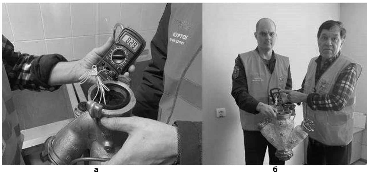
Рис. 3. Фрагменты проведения экспериментов по определению теплозащитной эффективности пожарного трехходового разветвления РТ-80
