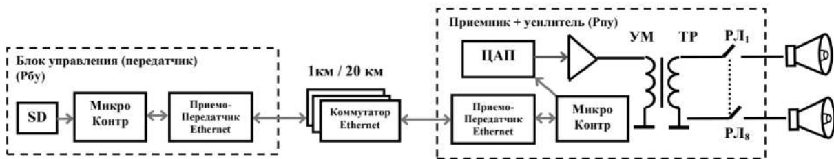
Рис. 3. Упрощенная схема функционирования централизованной системы оповещения ROXTON-8000 (дальность 1км / 20км).
