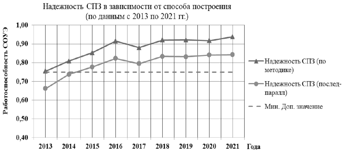
Рис. 7. Надежность СПЗ для различных структурных схем, построенная по статистическим данным ВНИИПО в период с 2013 по 2021 годы.
