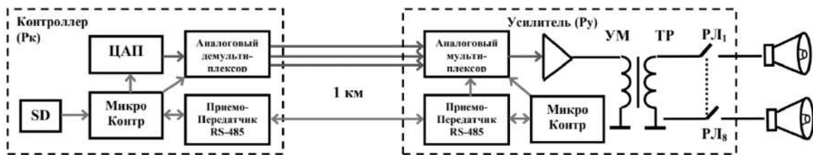
Рис.1. Упрощенная схема функционирования централизованной системы оповещения ROXTON-8000 (1 км дальности).
