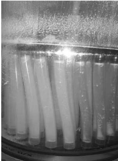
Рис. 4. Вид кассеты после пропускания пылегазового потока
