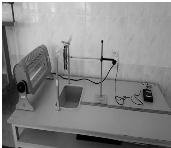
Рис. 1. Установка для определения уровня пропускания теплового потока, по которой проводилось исследование
