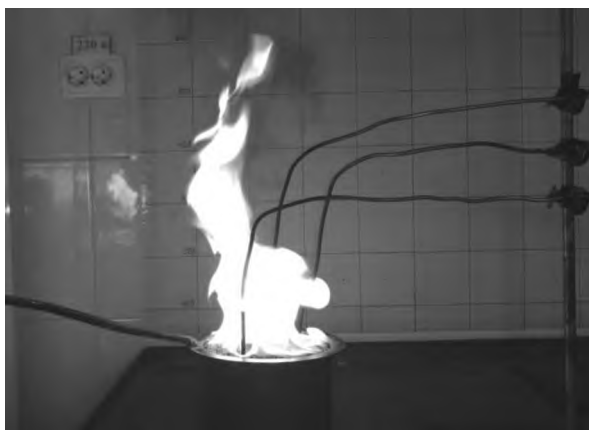
Рис. 3. Горение бензина в емкости диаметром 150 мм с подложками из гранул пеностекла высотой 70 мм и без подложки: а) без подложки; б) фракция 20–30 мм; в) фракция 10–20 мм г) фракция 5–7 мм; д) фракция 1–5 мм
