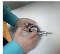
**Рис.6.** Заполнение полости сигнального устройства водой
