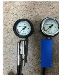
Рис.12. «Защитный чехол», установленный на сигнальное устройство (справа)
