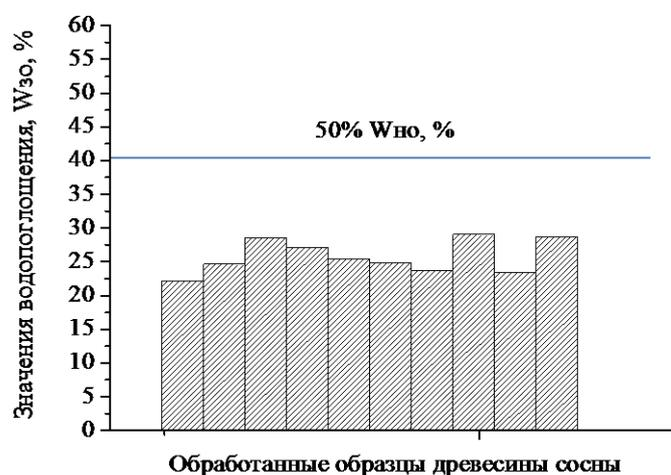
**Рис. 5.** Результаты испытаний на водопоглощение образцов древесины сосны
