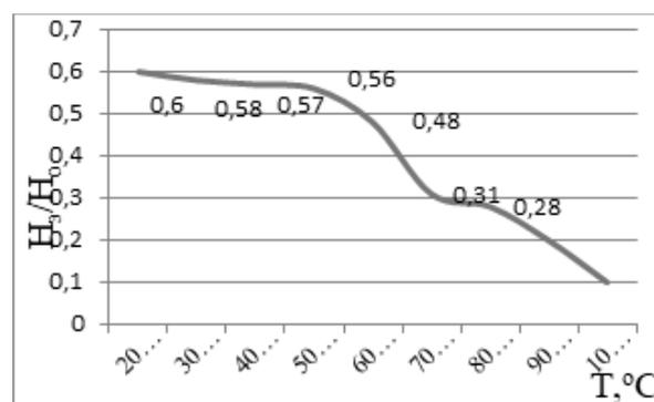
**Рис. 2.** Зависимость изменения соотношения  $N_z/N_0$  от температуры нагрева бетона класса В 25
