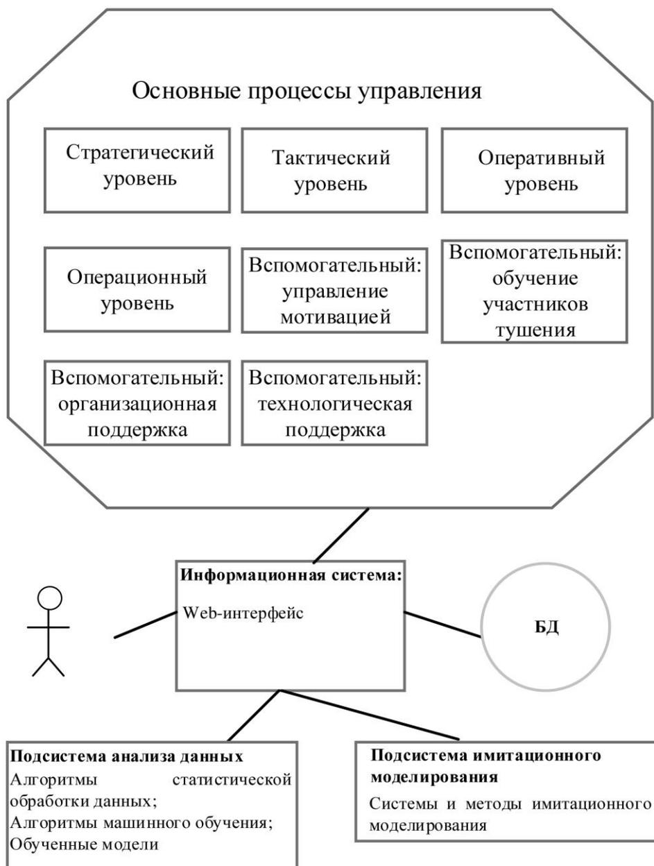
**Рис. 4.** Архитектура системы поддержки принятия решений по управлению подразделениями пожарной охраны при тушении пожара (БД–база данных)
