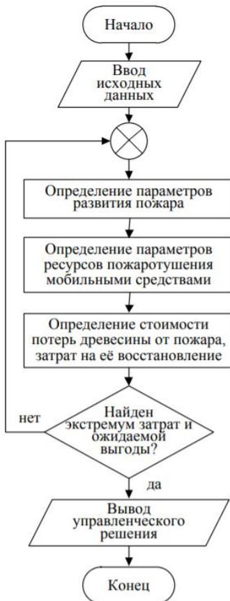
**Рис. 8.** Блок-схема поддержки принятия управленческого решения о достаточности сил и средств пожаротушения
