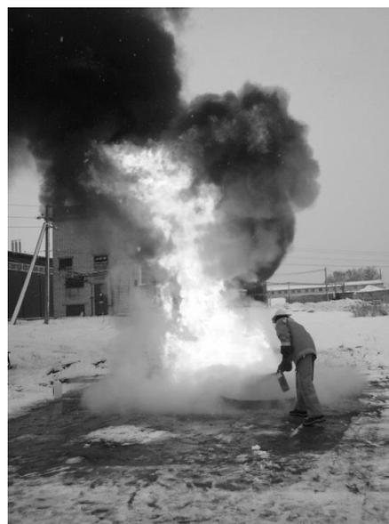
**Рис. 6.** Промышленные испытания огнетушащего порошка с микрокапсулами с хладоном
