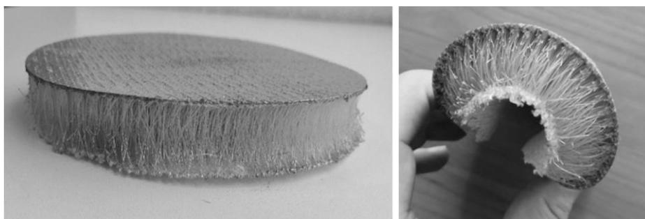
**Рис. 1.** Объемный композиционный полимерный материал
