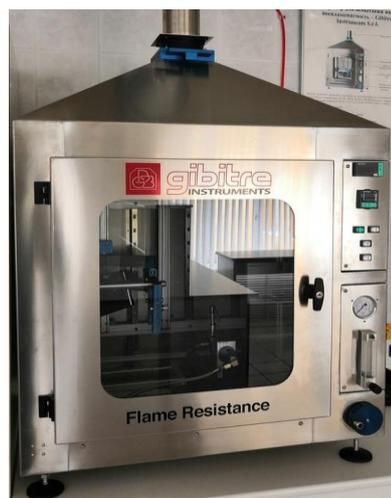
Рис. 1. Камера для испытания на горение (воспламеняемость) материалов Gibitre Flame Resistance
