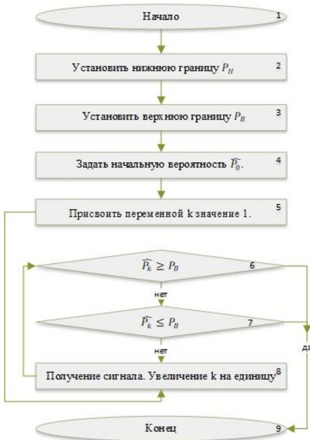
**Рис. 2.** Блок-схема алгоритма ППР при обнаружении судов, терпящих бедствие
