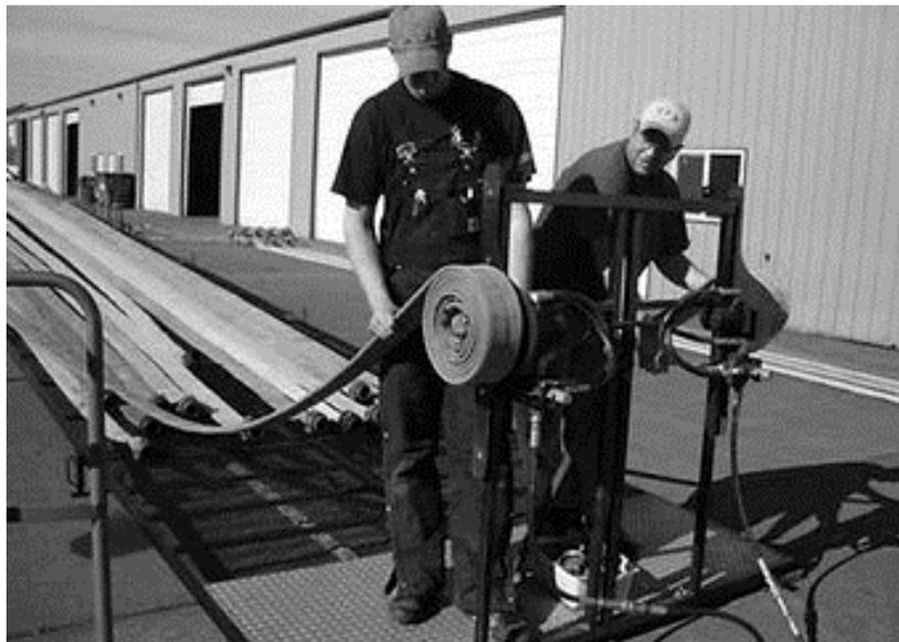
**Рис. 7.** Специалисты компании NHTS, Inc. проводят тестирование рукавов
