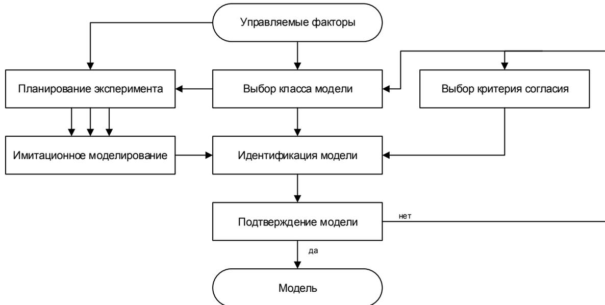
**Рис. 3.** Структурная схема методики идентификации модели
