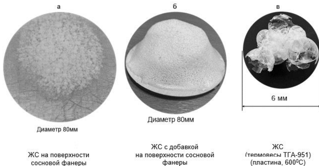
Рис. 2. Внешний вид образцов жидкого стекла после нагревания
