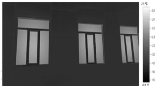
Рис. 6. Результаты тепловизионного обследования: а – фрагмент стены; б – термограмма
