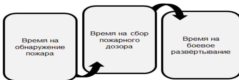
Рис. 2. Реагирование пожарного расчета (дозора)
