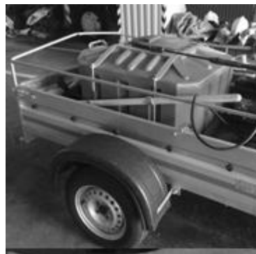
Рис. 3. Прицепной пожарный модуль для квадроцикла
