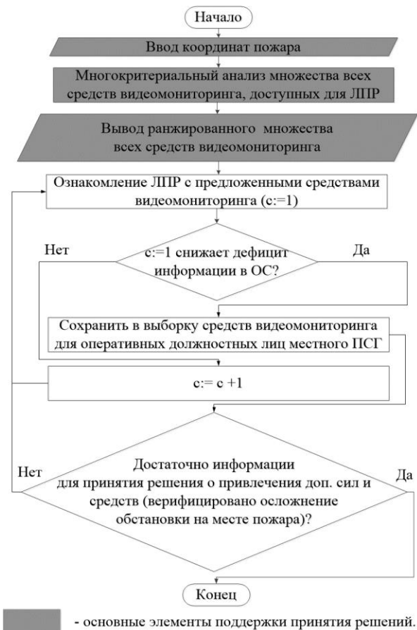
Рис. 5. Алгоритм информационной поддержки принятия решений для оптимизации параметра 1 (формула 1)
