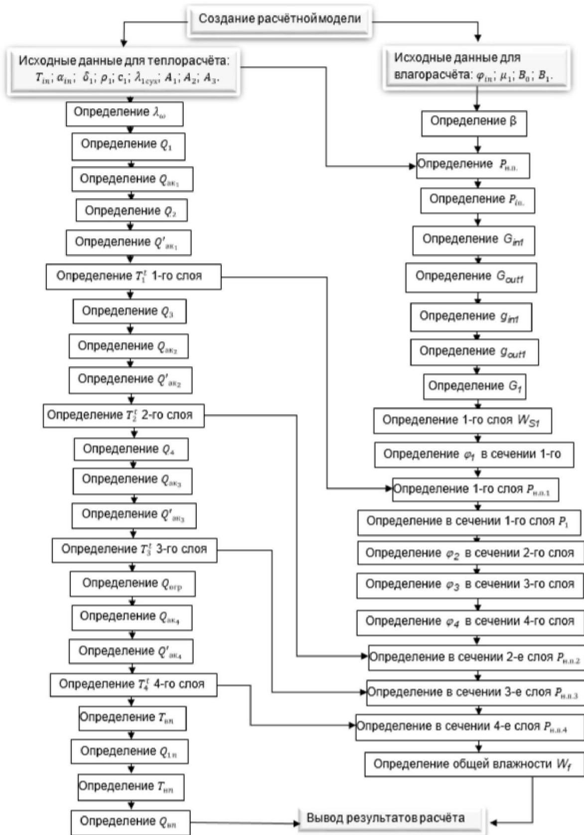
Рис. 4. Блок-схема алгоритма расчёта нестационарного режима тепло- и влагопереноса ограждающих конструкций
