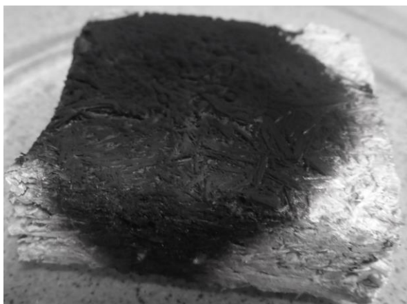
Рис. 3. Фрагмент древесно-стружечной плиты после воздействия источника открытого огня
