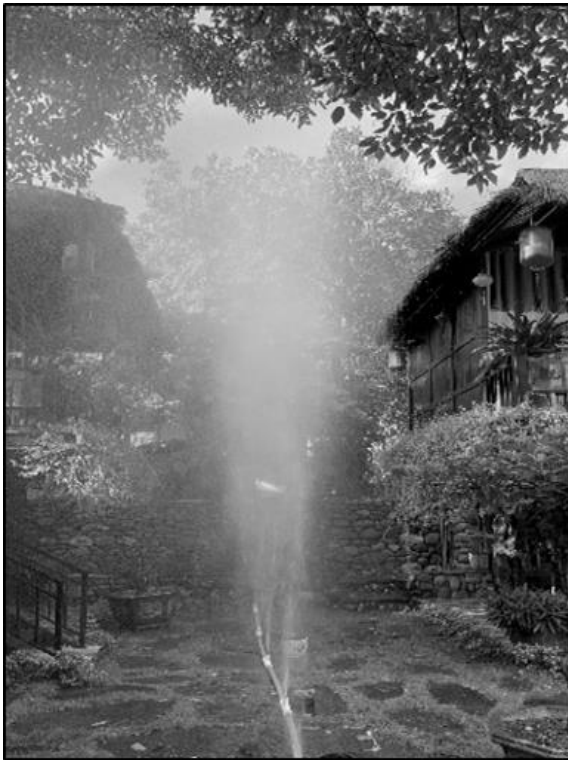
Рис. 4. Водяная завеса, полученная при испытании экспериментального образца перфорированного трубопровода с непрерывным расходом, выполненного в стационарном варианте
