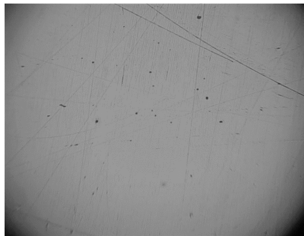
Рис. 3. Фотография образца стали после черного шлифования под увеличением
