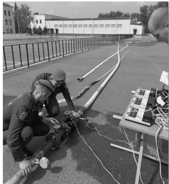
Рис. 2. Экспериментальная установка в сборе, использованная для получения фактических значений гидравлических сопротивлений РПН со стенками из современных материалов с условным проходом Ду80, Ду65, Ду50
