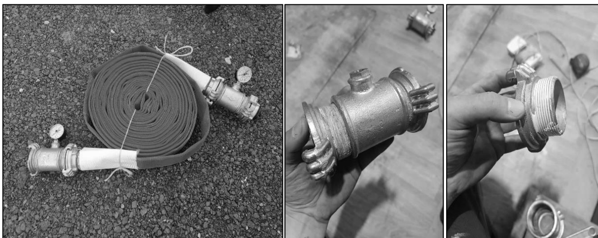
Рис. 5. Экспериментальный образец гибкого перфорированного трубопровода с непрерывным расходом, выполненный в мобильном варианте
