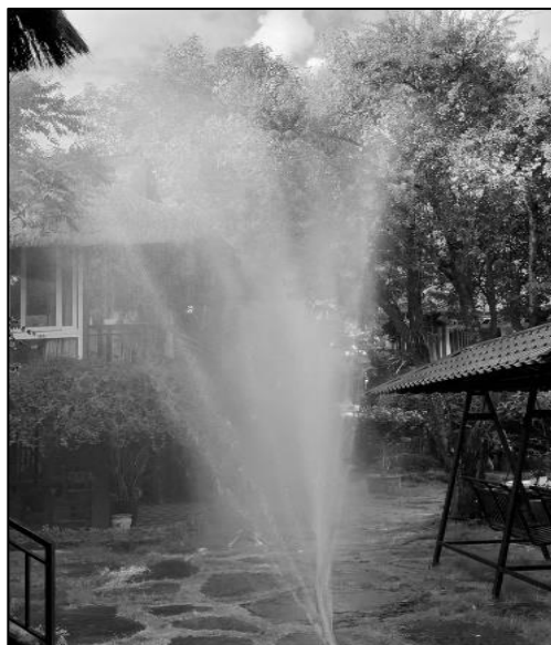
Рис. 5. Экспериментальный образец гибкого перфорированного трубопровода с непрерывным расходом, выполненный в мобильном варианте
