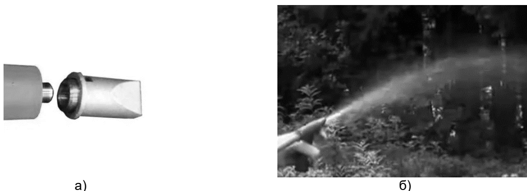
Рис. 3. Насадок распылитель гидропульты лесопожарного ранца: а) общий вид; б) формирование распыленной струи
