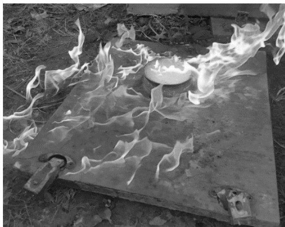
Рис. 3. Расплескивание горючего струей воздухозаполненной пены и увеличение площади горения
