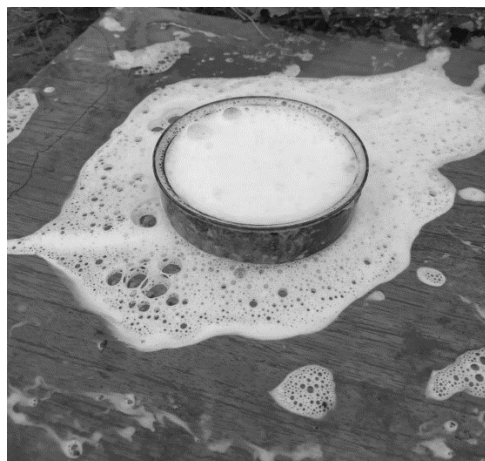
Рис. 4. Слой газонаполненной пены на поверхности очага
