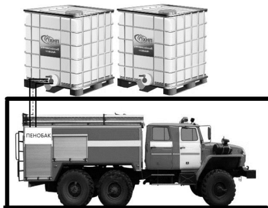
Рис. 4. Способ заправки пенобака самотёком
