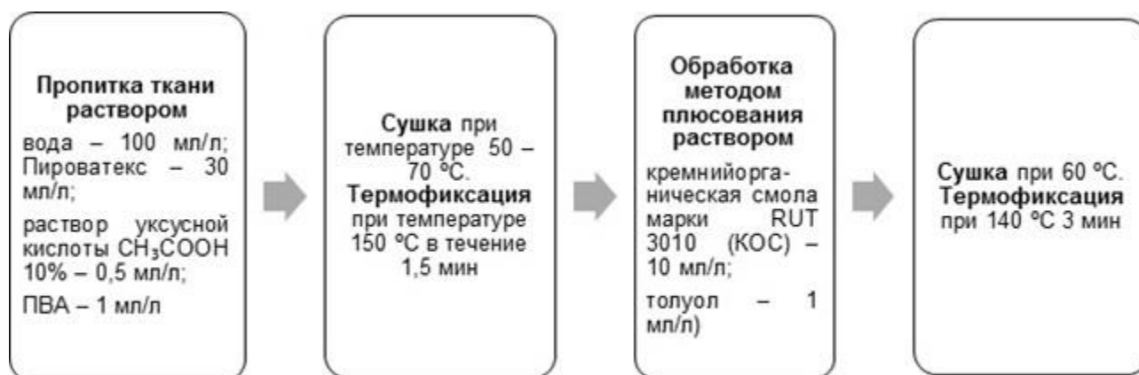
Рис. 6. Способ огнезащиты хлопко-полиэфирной ткани на основе Пироватекса и кремнийорганической смолы, растворенной в толуоле
