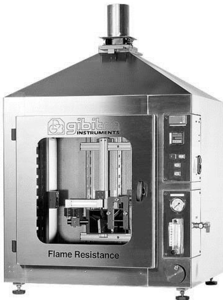
Рис. 10. Лабораторная установка для испытаний на воспламеняемость материалов компании Gibitre Instruments S.r.l.
