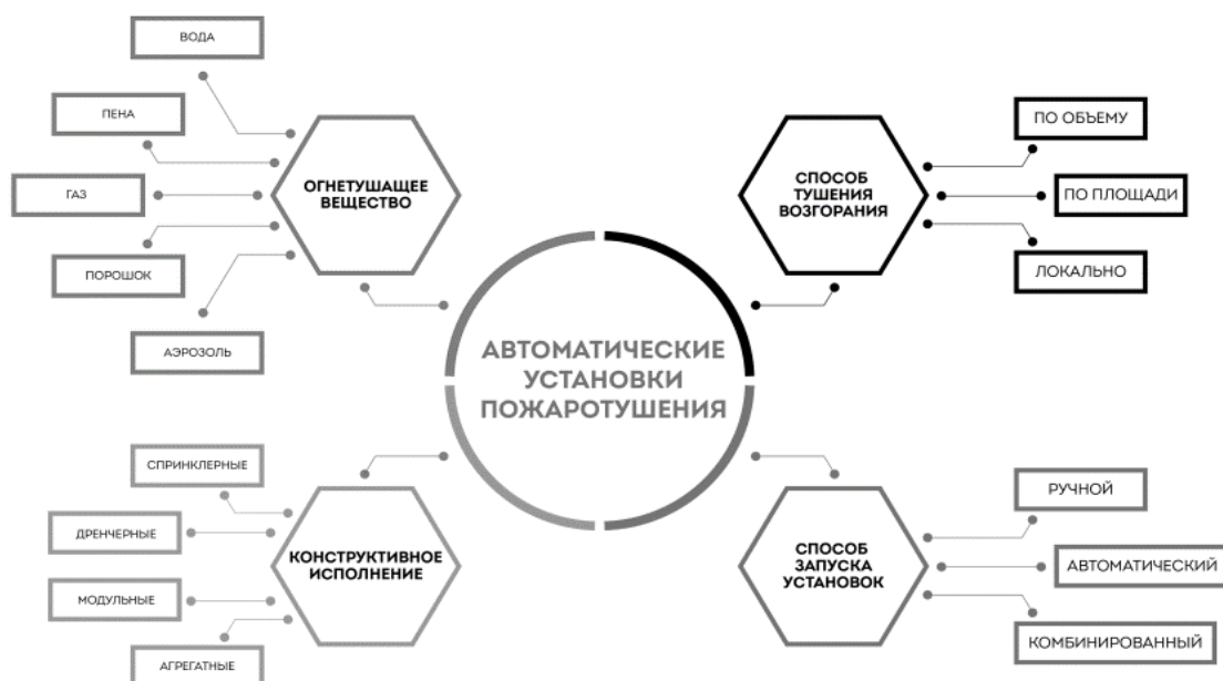
Рис.1. Классификация автоматических установок пожаротушения
