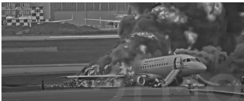
Рис. 2. Состояние фюзеляжа Sukhoi Superjet 100-95B в 18 ч 32 мин 12 с (подача первого лафетного ствола от аэродромного автомобиля)
