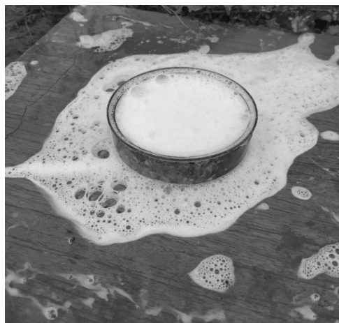
Рис. 4. Слой газонаполненной пены на поверхности очага
