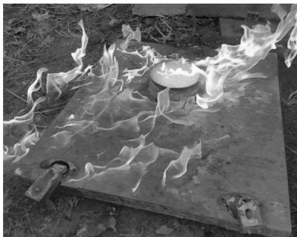
Рис. 3. Распыливание горючего струей воздухозаполненной пены и увеличение площади горения
