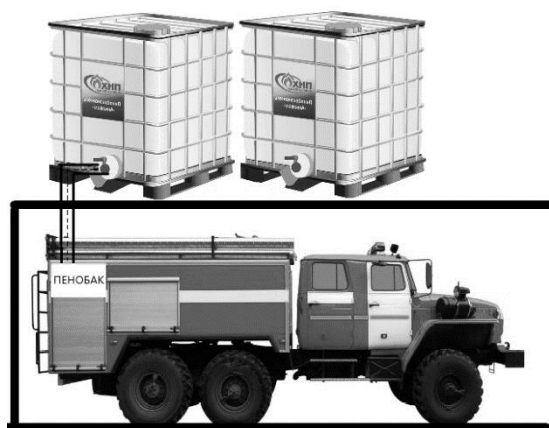
Рис. 4. Способ заправки пенобака самотёком
