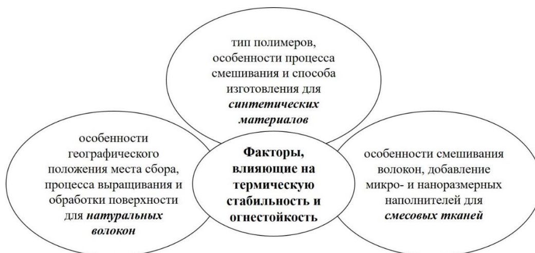
Рис. 1. Факторы, влияющие на термическую стабильность и огнестойкость композитов из натуральных волокон
