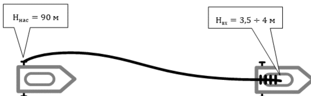
Рис.1. Методика перелива воды между автоцистернами по системе «из насоса в цистерну» с использованием специального люка на крыше
