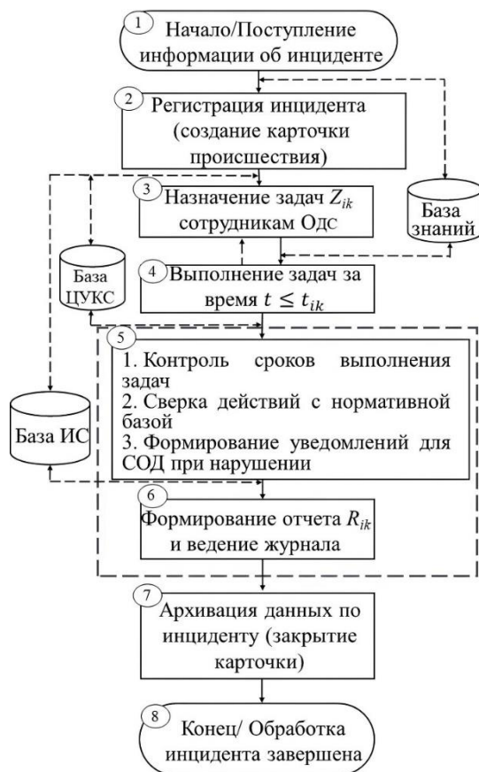
Рис. 6. Алгоритм работы информационной системы обеспечения деятельности ОДС
