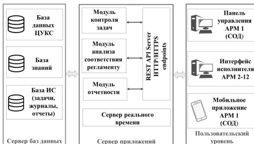
Рис. 5. Трехуровневая архитектура информационной системы обеспечения деятельности ОДС
