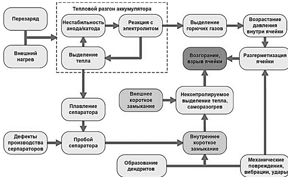
Рис.1. Схема возможных причин возгорания литий-ионных аккумуляторов
