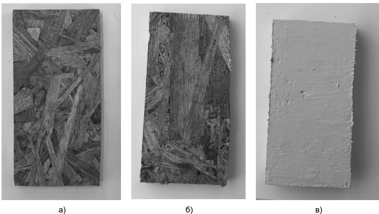
Рис. 2. Внешний вид образцов OSB-плит (размеры образцов 150×75×25 мм) до воздействия пламени горелки под углом 90°: а) без обработки, б) образец, обработанный составом 1, в) образец, обработанный составом 2
