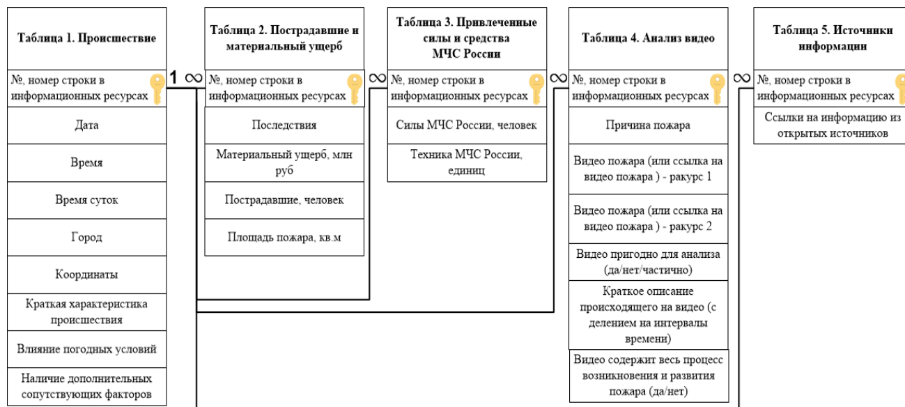
Рис. 4. Схема базы данных (таблицы, атрибуты данных и связи между таблицами)
