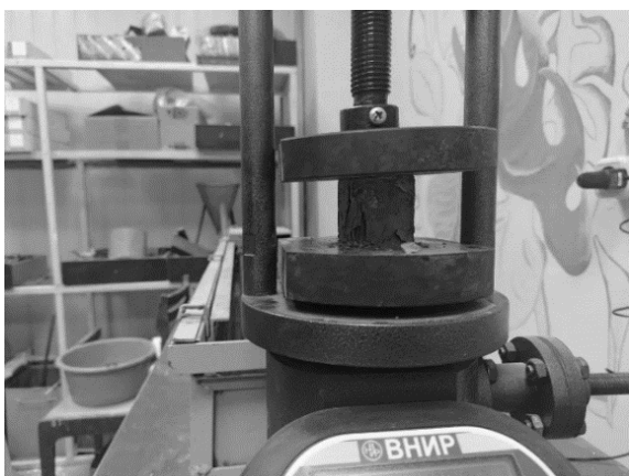
Рис. 2. Определение прочности при сжатии образцов 40х40х40 мм из приведённых составов лёгких бетонов
